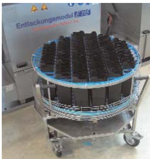
Entlackung von Alu-Blenden – Beispiel für gesteckte Bestückungsanordnung
