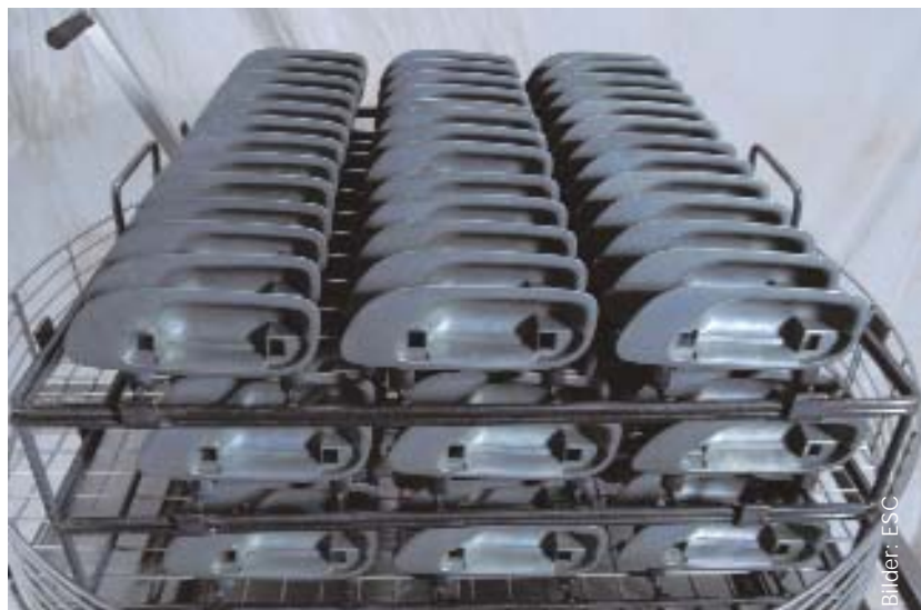
Das Beispiel dieser Griffschalen zeigt, wie der Korb der Entlackungsanlage mehrlagig bestückt werden kann
