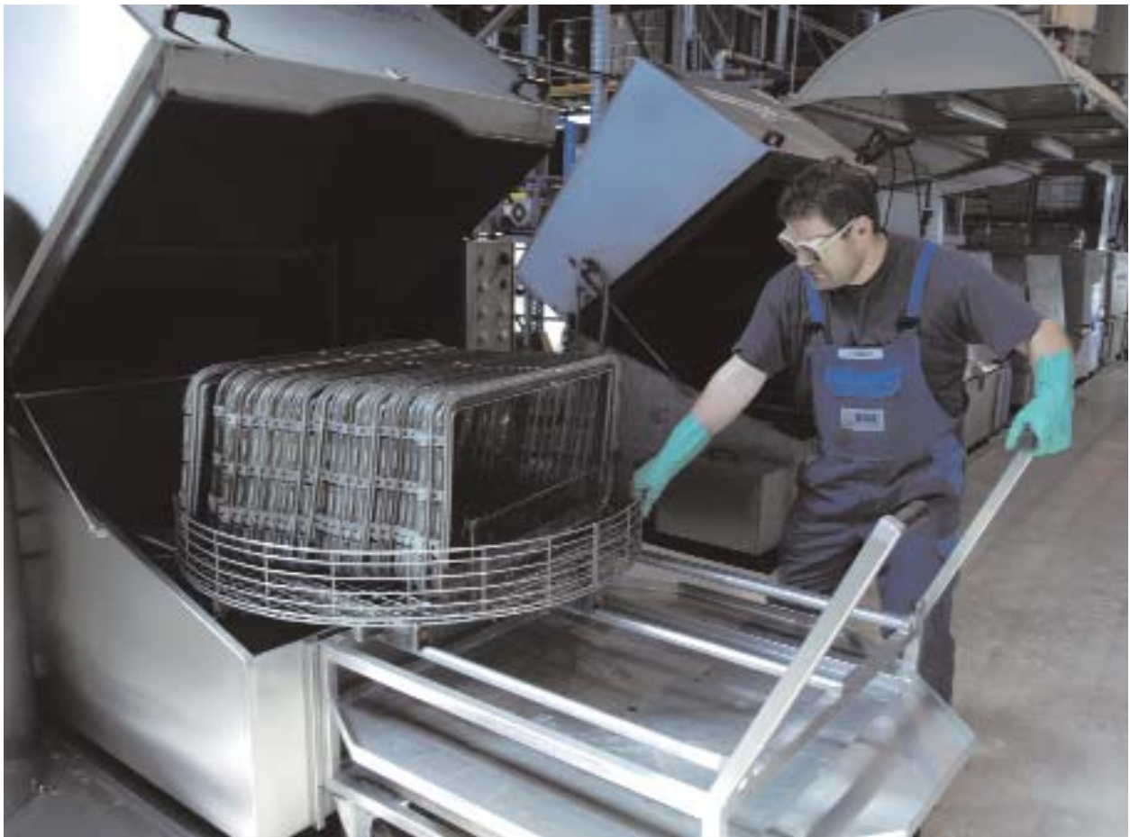
Die entlackten Teile werden mit Hilfe des Fahrwagens entladen
