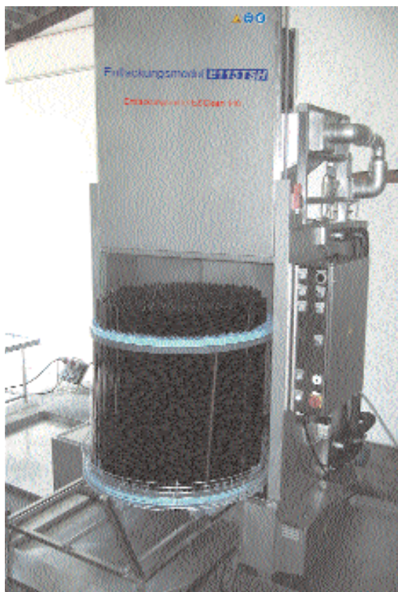
Die neue Anlage zur Spitzentlackung mit Lösemittel verfügt über einen integrierten Schwadenkondensator mit geschlossenem Kühlwasserkreislauf. Eine Ableitung der Dampfschwaden ist nicht mehr erforderlich.
