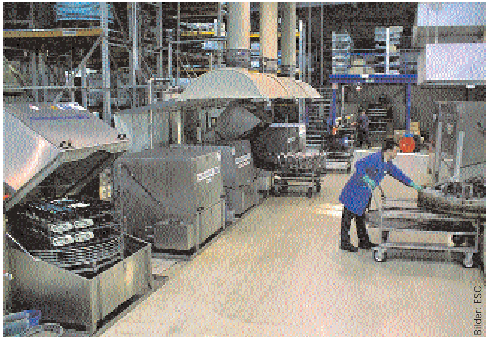
Moderner Entlackungsbetrieb mit mehreren Entlackungs- und Nachspülmodulen und zentraler Absauganlage über Abluftwäscher
